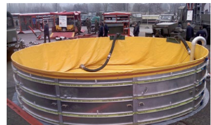
Bassin rigide composé d'éléments en aluminium p. ex. 50'000 l
