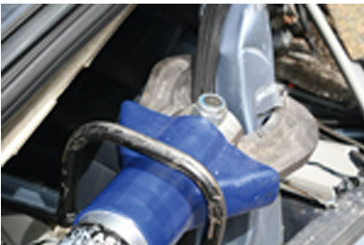
Cisailles hydrauliques à un angle de 90°
