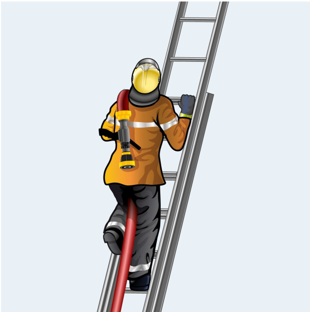
Façon de gravir une échelle avec une conduite de refoulement
