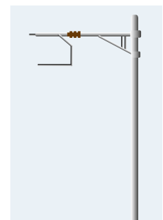
Ligne de contact p. ex. CFF 15 kV
