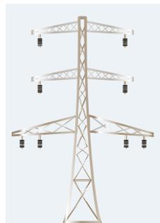
Pylône métallique en treillis, p. ex. 220 kV
